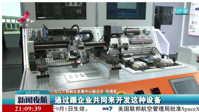
图 2-3 校企联合开发工业互联网设备数据采集实训平台
